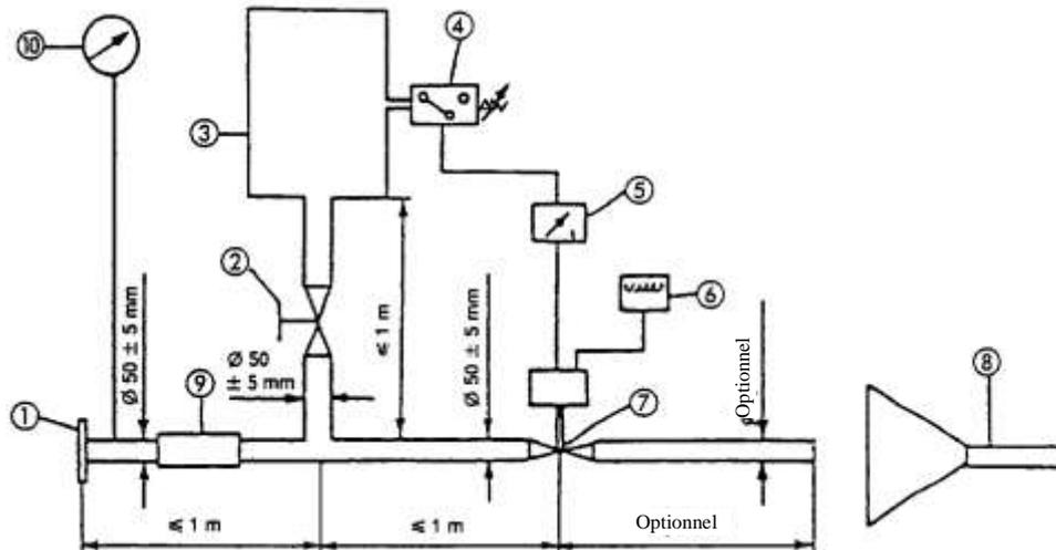
1. Bride ou manchon de raccordement à la sortie du système de silencieux d'échappement complet à essayer.
