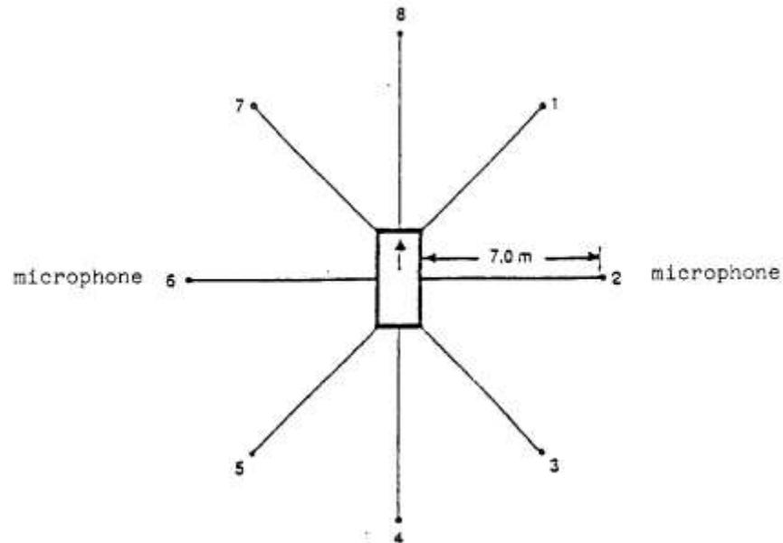
Les mesures se font sur le véhicule à l'arrêt, comme indiqué sur la figure 1, à partir de deux positions du microphone, à 7 m du contour extérieur du véhicule, et à une hauteur de 1,2 m au-dessus du sol.
